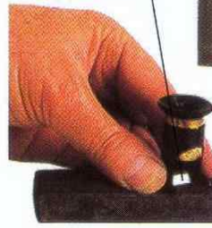
مقياس لتحديد عرض التجويف الذي أحدثته آلة الاختبار
