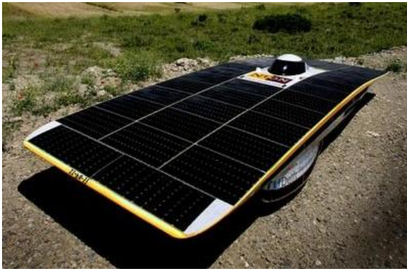
السيارة Nuna التي تعتمد على بطارية كهربائية تُشحن بواسطة الطاقة الشمسية... تعتبر Nuna أسرع سيارة شمسية في العالم حيث فازت في بطولة العالم للعام 2005... تبلغ سرعتها القصوى 130 كم/س.
