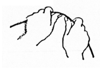
شكل رقم (١٢١) عملية ثني الموصل.
