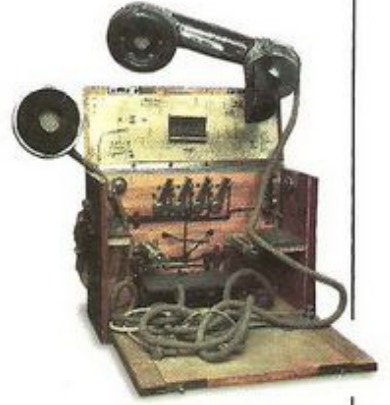
تليفون الميدان كانت التليفونات وسيلة الاتصال الأساسية بين خط الجبهة والمقر الرئيسي. كانت تنقل الأصوات ورسائل مورس المشفرة.
