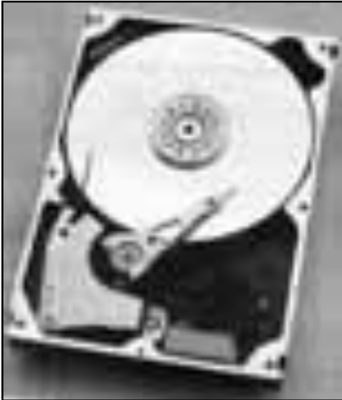
(٢٥٨) الأسطوانة الصلبة التي تسجل عليها الآن في أغلب الكاميرات الفيديو الحديثة ويمكن تقيفه والتصوير عليها مرات عديدة
