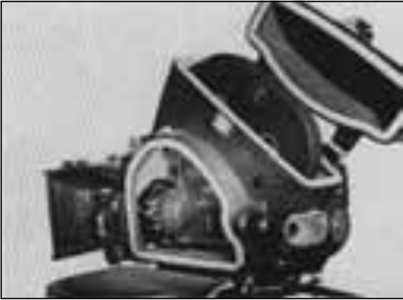
(١٢٣) الكاميرا الألمانية أريفلكس داخل بلمب أخف وأسهل وصلى أكثر - جسم البلمب مفتوح للإيضاح
