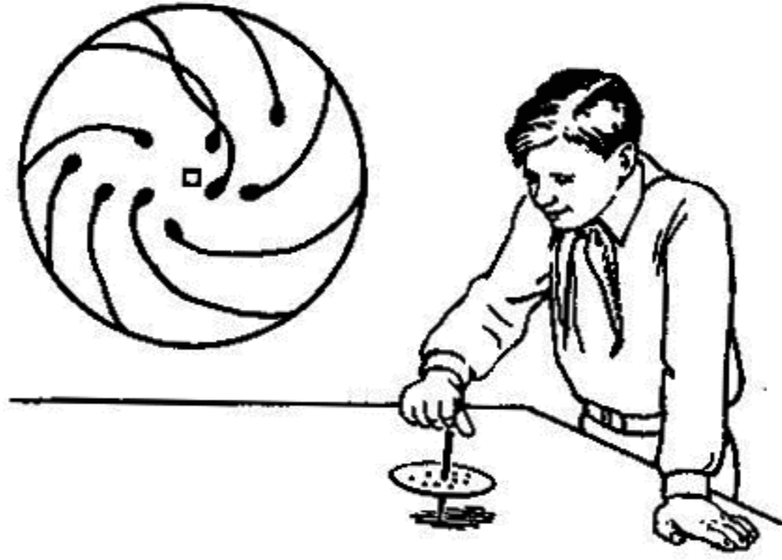
شكل ٤٢ : كيفية انسياب قطرات الحبر على قرص الورق الدوار .
